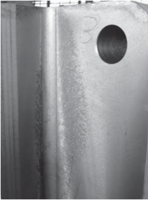
Bild 3. Dunkle Schattierungen auf der bearbeiteten Oberfläche des Deckels aus Gusseisen mit Kugelgraphit
