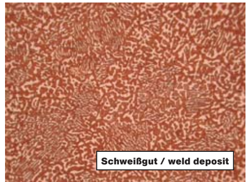
Bild 7. Duplex-Gefüge im Schweißgut. Ferrit zeigt sich als dunkle Phase (geätzt nach Adler; ursprüngliche Vergrößerung ca. 150-fach).
