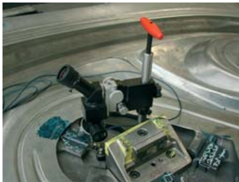
Bild 10. Tragbares Mikroskop auf einer Matrize für ein Karosserie-Seitenteil
