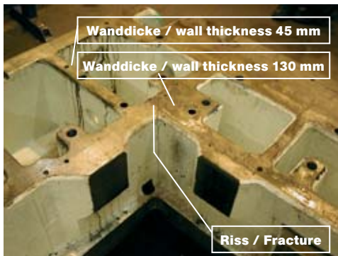
Bild 8. Gerissenes Werkzeug einer Karosserie-Pressen aus GGG-70 L.
