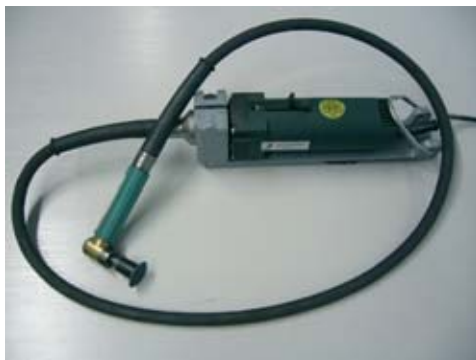
Bild 1. Schleif- und Poliermaschine mit biegsamer Welle
