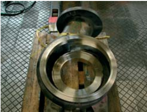
Bild 5. Pumpengehäuse aus Duplex-Stahlguss 1.4517
