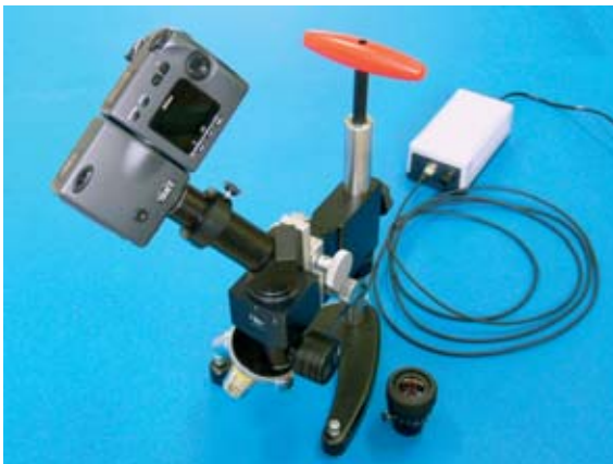
Bild 2. Auflichtmikroskop mit aufgesetzter Digitalkamera
